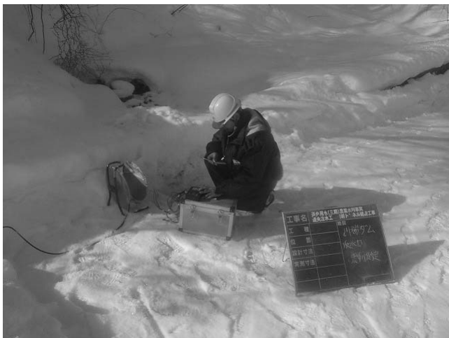
写真－8 振動測定状況
