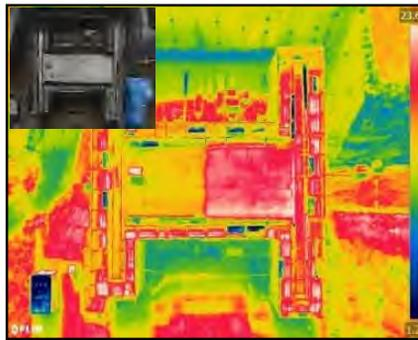
場所打函渠工温度分布状況
