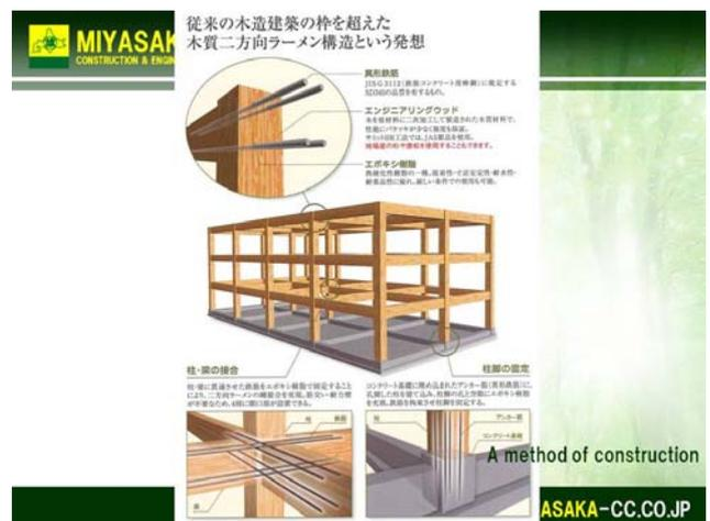
木質二方向ラーメン構造が採用されています。継ぎ手には金物は使用せず、代わりに鉄筋材を挿入し接着剤を注入することで木の梁を接合しています。
