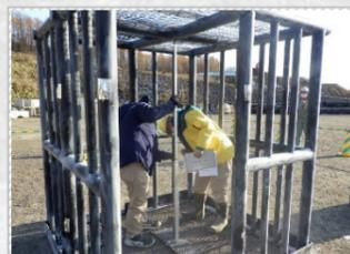
マンゲージの天端に約200tf（トンフォース）を超える衝撃力が作用。結果として天端中央部で最大14mm内側に押し曲げられました。鉛直方向での変形量はほぼゼロ、水平方向の変形量もなく、支柱部材への影響はほとんどありませんでした。
