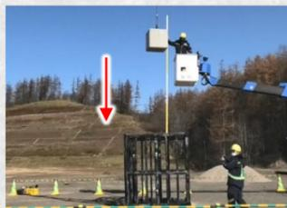
耐久試験は、マンゲージに加速度計2か所、ひずみ計12か所を設置し、無筋コンクリート、一辺約60cm、重量570kgの立方体を岩塊と見立て、高さ2.8mの地点から自由落下させました。
