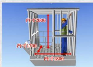
マンゲージの中は幅1.7m、奥行が1.8m、内空高さが2.0mとなっており作業員2名がラクラク作業できる広さとなっています。最大積載荷重は300kgとなっており資材も十分に積み込むことができます。
